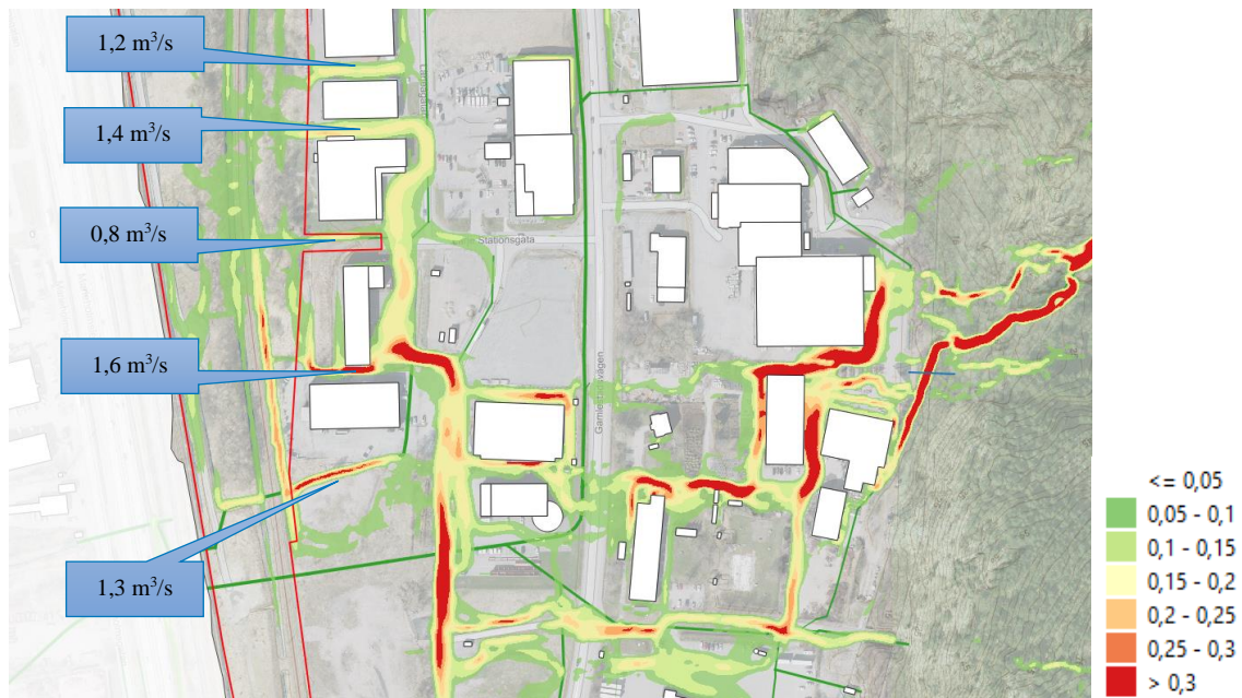
Figur 4: Inzoomat vid mitten av planområdet där ytflöden kommer in. Färger visar maximalt flux ( \text{m}^2/\text{s}/\text{m} ). Totalt ytligt inflöde till planen är upp till 8\text{ m}^3/\text{s} som kommer in österifrån.
